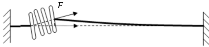
Рисунок А.14 – Нарушение соосности под воздействием боковых усилий
